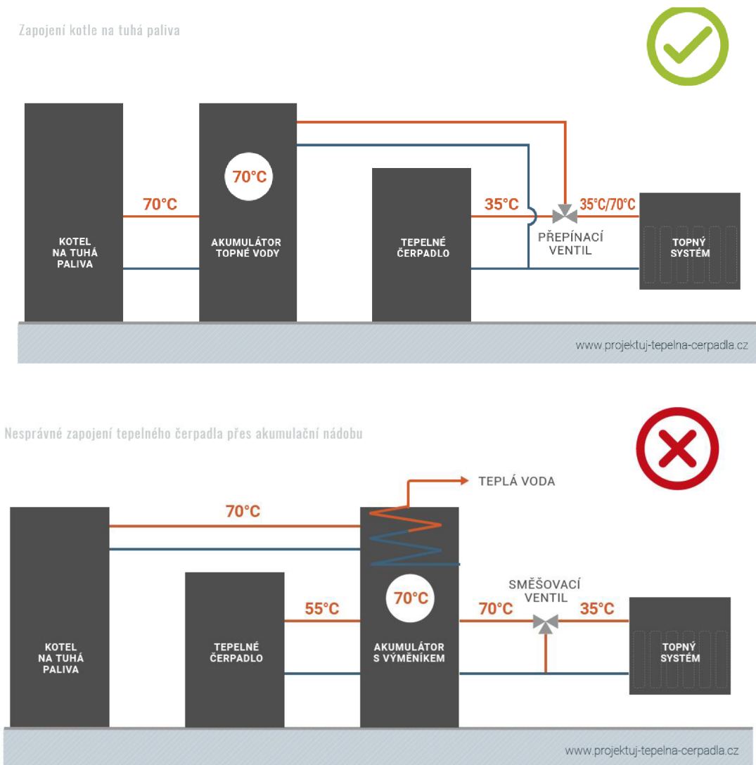
Obrázek 5: zjednodušené schéma zapojení, projektuj tepelná čerpadla [13]
