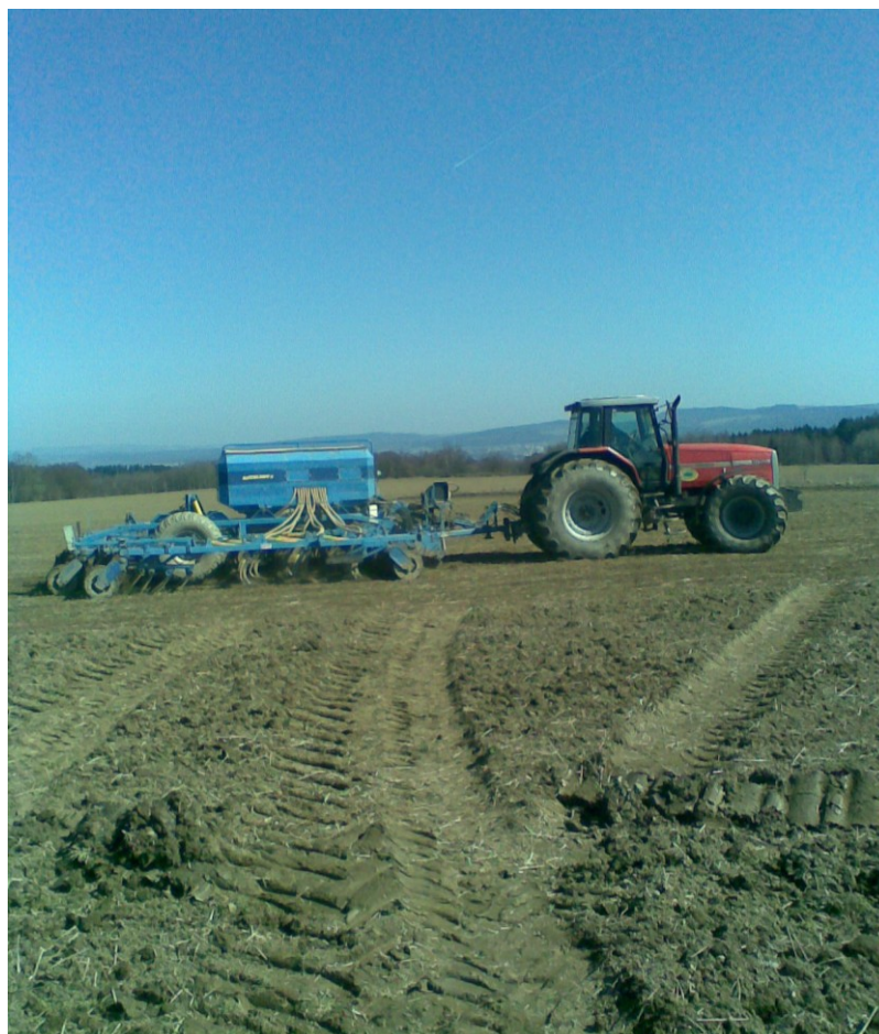
Obr. 3: Seti hořčice bílé radličkovou secí kombinací Excelent tažené traktorem Massey Ferguson 8170, 5. 4. 2010
