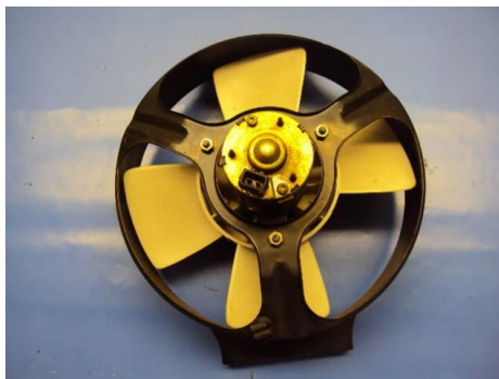
Obr. 24 Ventilátor u chladiče
