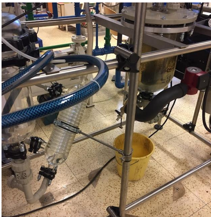
Obrázek 18 Stripovací zařízení připravené pro absorpci amoniaku
