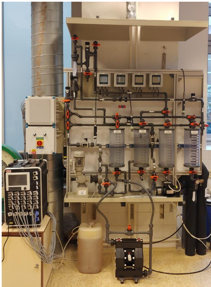
Obrázek 12 Kontaktorová stěna v laboratoři chemického inženýrství
