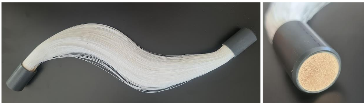
Obrázek 14 Krátký svazek vláken P60 a detailní záběr na potting
