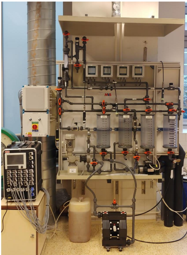
Obrázek 12 Kontaktorová stěna v laboratoři chemického inženýrství
