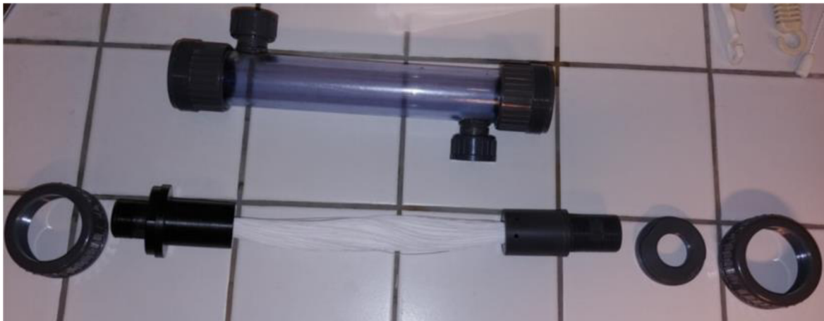
Obrázek 15 Demontovaný membránový modul
