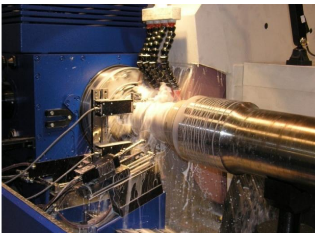
Obr. 4.10 Ukázka broušení válcové plochy s intenzivním chlazením a snímáním průměru broušené součásti sledovací měřidly Amest [3].
