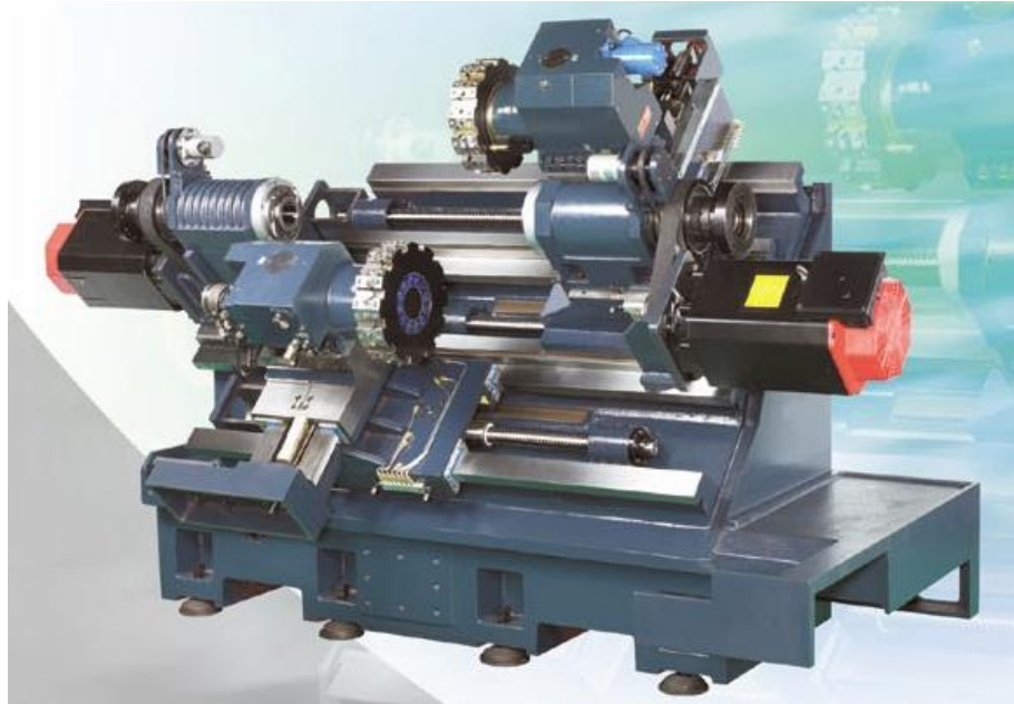
Obr. 4.6 Skelet obráběcího centra JOHNFORD HT30-2SD [9].
