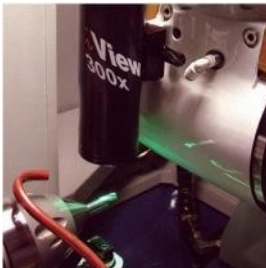
Obr. 6.2 Integrované měřicí zařízení iView ve stroji ANCA [5].
