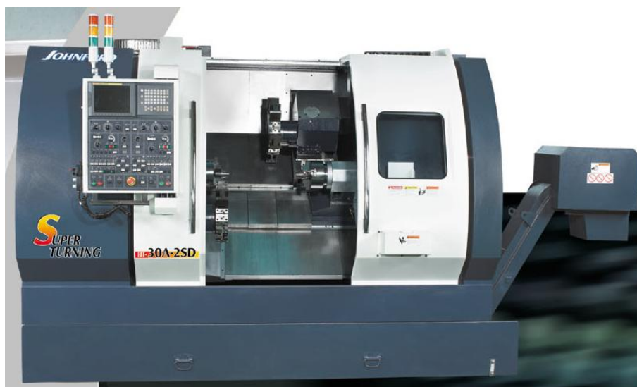
Obr. 4.5 Obráběcí centrum JOHNFORD HT30-2SD [9].
