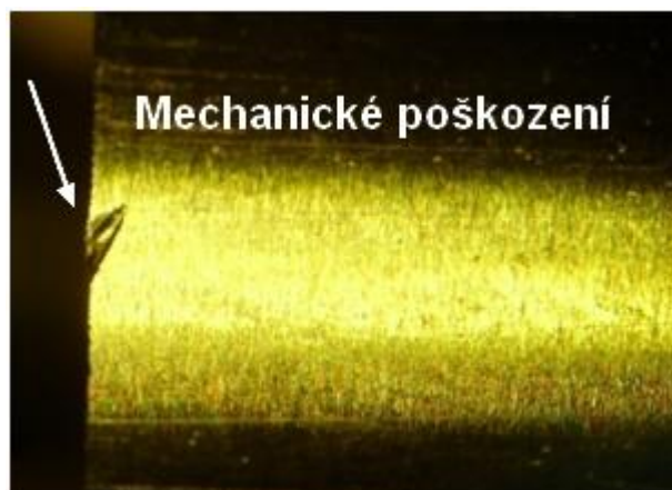
Obr. 2.7 Mechanické poškození hrany na čele pístu.
