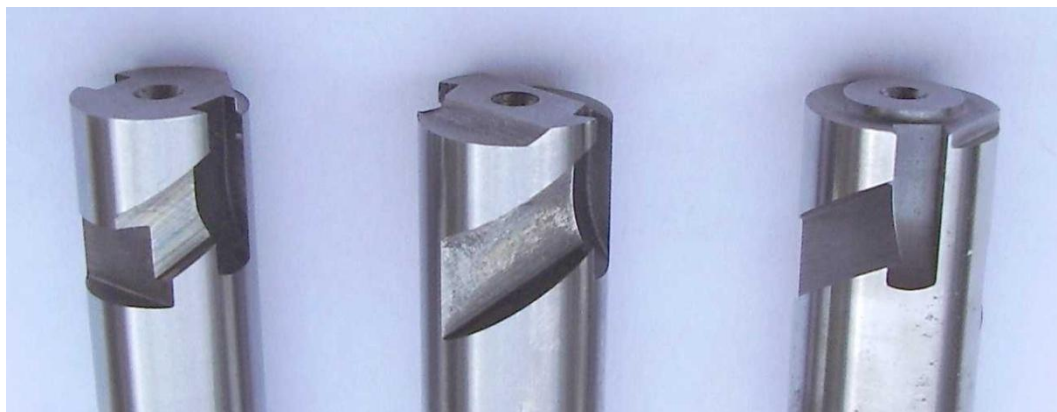
Obr. 1.4 Ukázka regulačních drážek.
