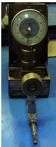
Obr. 2.10 Pneumatické měřidlo vůle ETAMIC a výměnný snímač.
