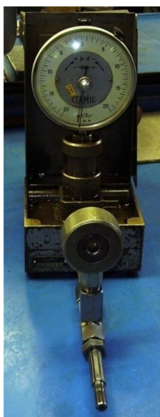
Obr. 2.10 Pneumatické měřidlo vůle ETAMIC a výměnný snímač.
