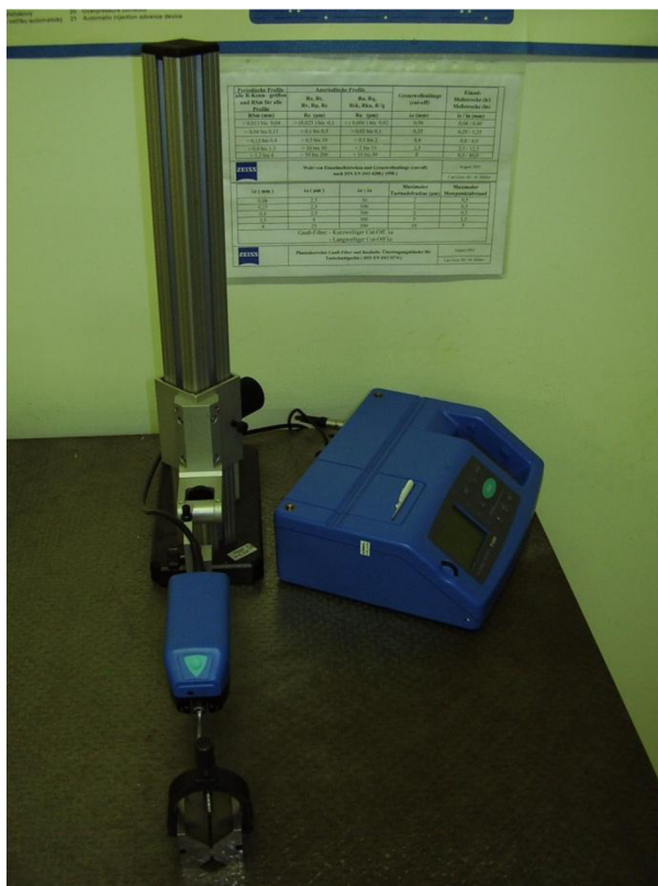
Obr. 6.5 Měřidlo střední aritmetické úchytky profilu Hommel Tester T1000.
