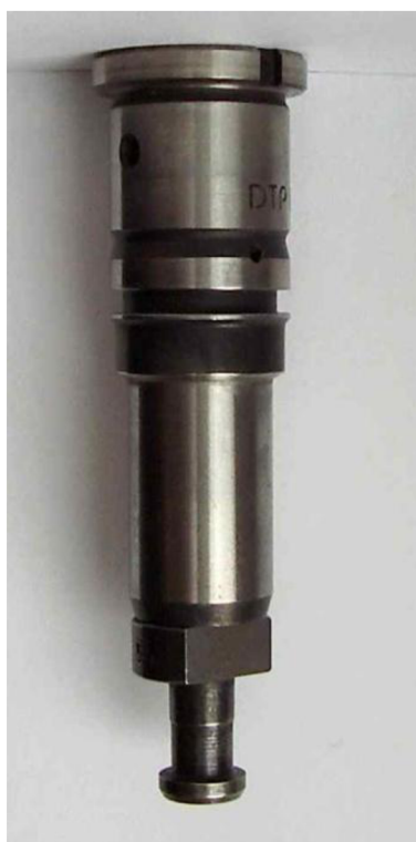
Obr. 1.8 Element vstříkovacího čerpadla a část výkresové dokumentace.
