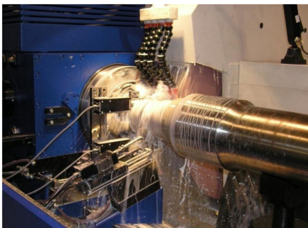
Obr. 4.10 Ukázka broušení válcové plochy s intenzivním chlazením a snímáním průměru broušené součásti sledovacími měřidly Amest [3].
