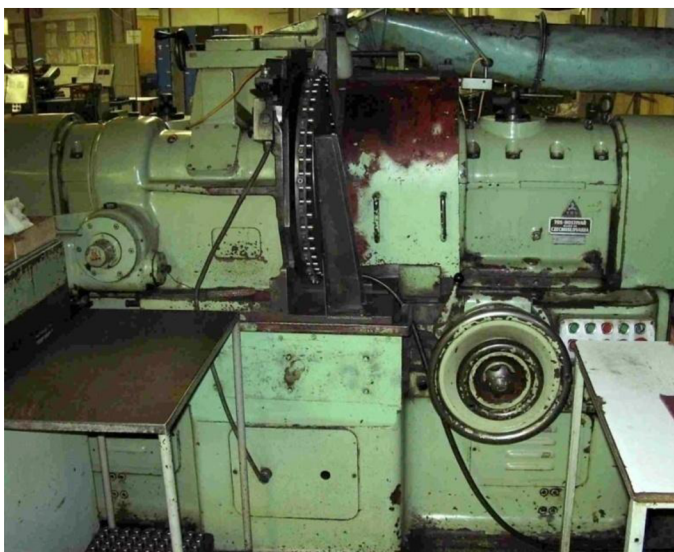
Obr. 1.10 Stroj BSBK pro broušení čel pístů.
