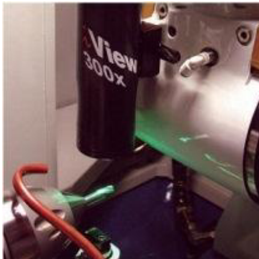
Obr. 6.2 Integrované měřicí zařízení iView ve stroji ANCA [5].
