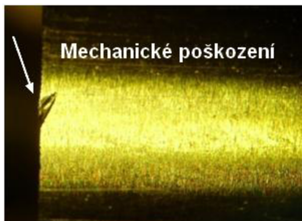
Obr. 2.7 Mechanické poškození hrany na čele pístu.
