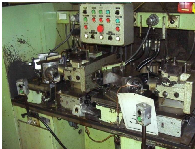
Obr. 1.11 Jednouúčelový stroj pro frézování drážek.
