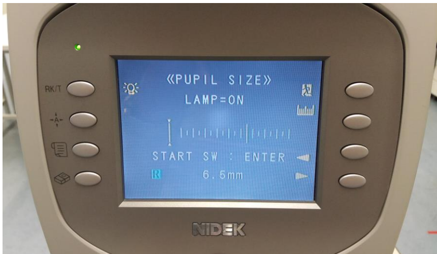
Obr. 27 Nastavenie prístroja na zmeranie priemeru zrenice
