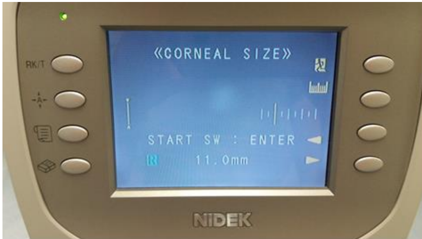
Obr. 26 Nastavenie prístroja na zmeranie priemeru rohovky
