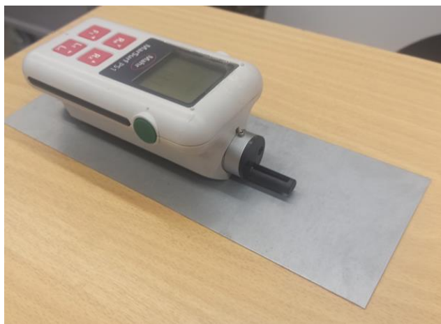
Obr. 3.5 Měření drsnosti povrchu pomocí přístroje MarSurf PS1
