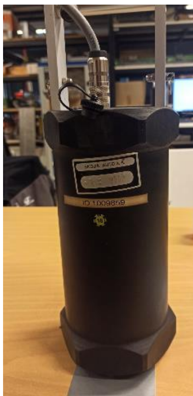
Obr. 3.6 Přístroj na měření tloušťky oleje – pohled zepředu
