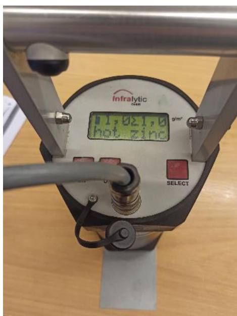
Obr. 3.7 Přístroj na měření tloušťky oleje – pohled shora
