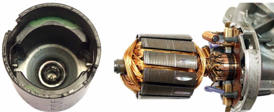
Obr. 2.3: Komutátorový motorek ze stírací jednotky, vlevo stator s permanentními magnety, vpravo rotor, komutátor s uhlíky a příruba
