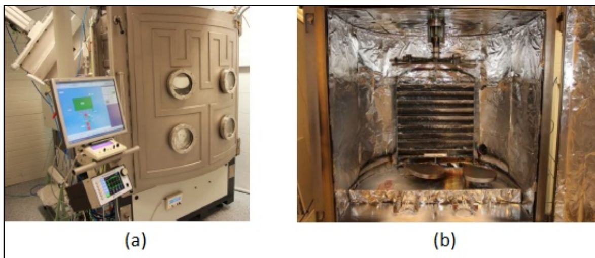
Obrázek 8 – Pohled na vakuovou aparaturu VSE 1200A, (a) pohled zvenčí, (b) pohled do nitra komory [3].
