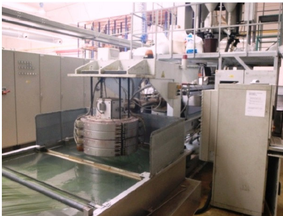
Obr. 4 Extruzní linka Barmag pro výrobu monofilamentů.[1]
