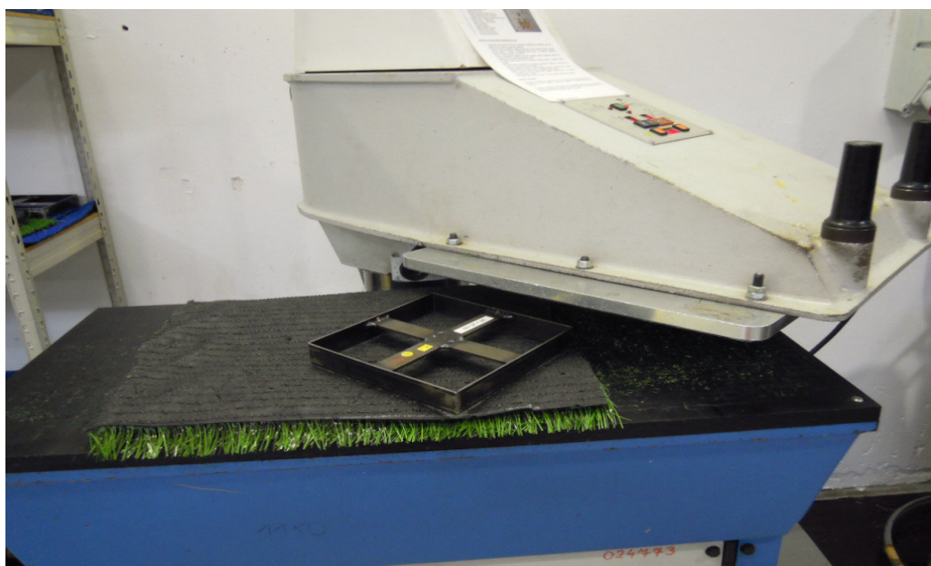
Obr. 13 Hydraulický vysekávací stroj s připraveným formátem materiálu a vysekávacím nožem.
