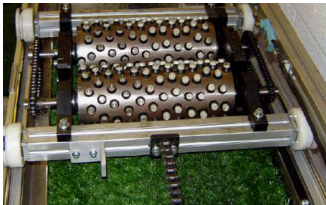
Obr. 9 Testovací zařízení pro odolnost povrchu opotřebení. [14]
