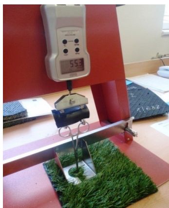
Obr. 8 Zařízení pro testování pevnosti ukotvení vlasu
