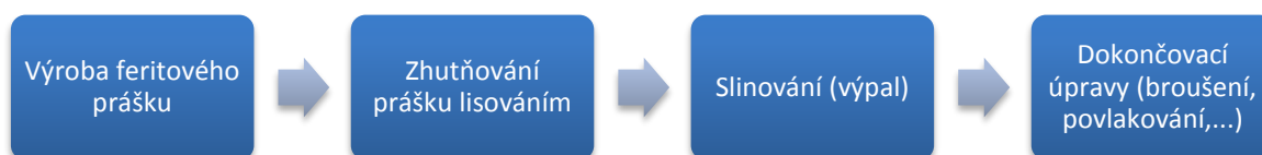
Obr. 3 Schéma procesu výroby feritových jader.
