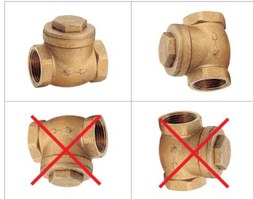
Obrázek 7 Dovolené orientace zpětných klapek na potrubí (13)
