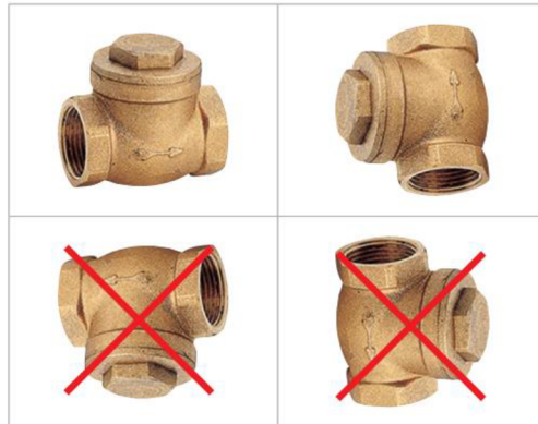
Obrázek 7 Dovolené orientace zpětných klapek na potrubí (13)
