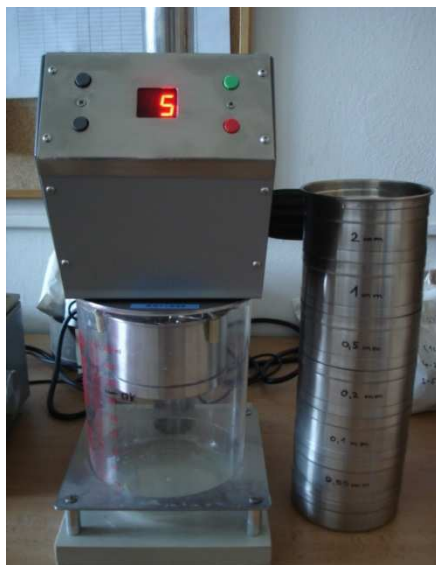
Obrázek 2 Aparatura dle Henin-Féodoroff pro simulaci heliakálního pohybu v ethyl-alkoholu (Huislová, 2013)
