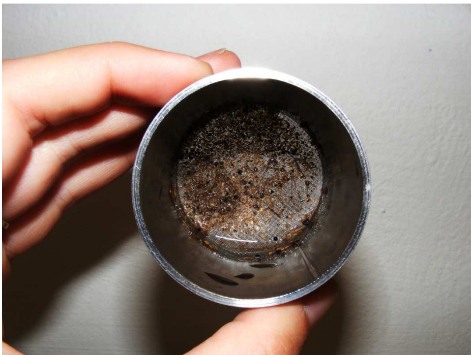
Obrázek 11 "Skelet" zbylý po rozbití stabilních agregátů, na sítu zůstává i organická hmota (Huislová, 2013)
