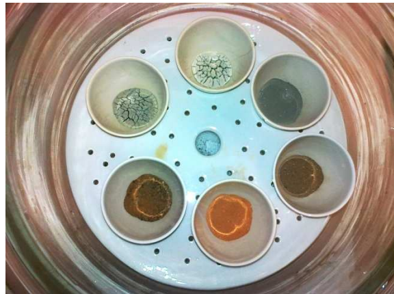
Obrázek 40 Výsledek metody LOI. Částice se žíhají v peci za teploty až 550 °C (Huislová, 2013)
