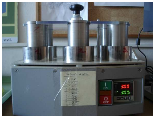
Obrázek 7 Aparatura dle Kemper et Rossenau (1986) (Huislová, 2013)
