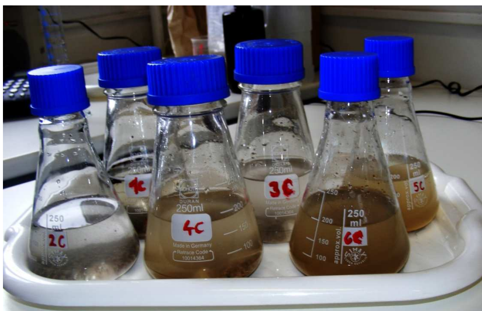
Obrázek 5 Test C - Mechanické rozrušení agregátů v Erlenmeyerových baňkách
