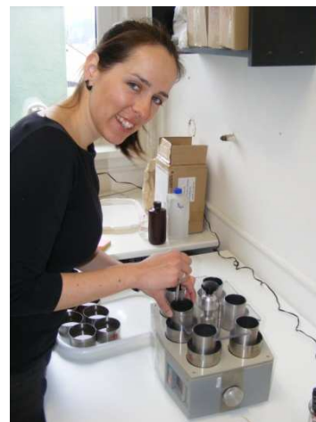
Obrázek 9 Drcení stabilních agregátů skleněnou tyčinkou (Batysta, 2013)
