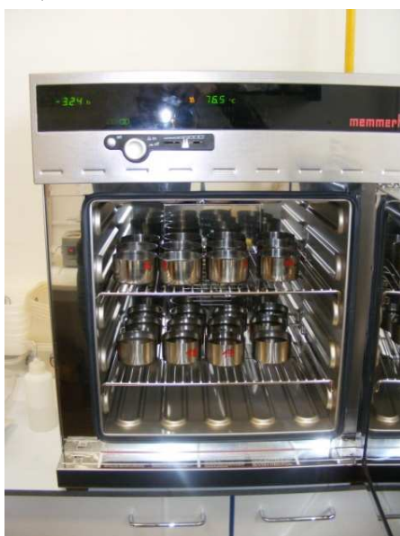
Obrázek 10 Vysoušení vzorků v horkovzdušné peci (Batysta, 2013)
