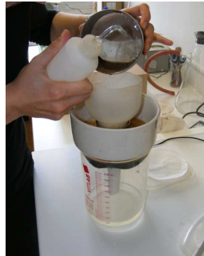
Obrázek 6 Přenášení agregátů ze síta do vysoušecí misky (Batysta, 2013)
