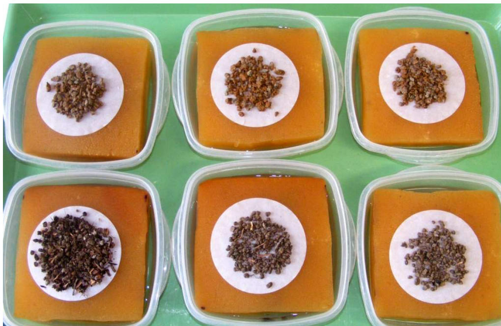
Obrázek 4 Test B - pomalé ovlhčení agregátů (Huislová, 2013)
