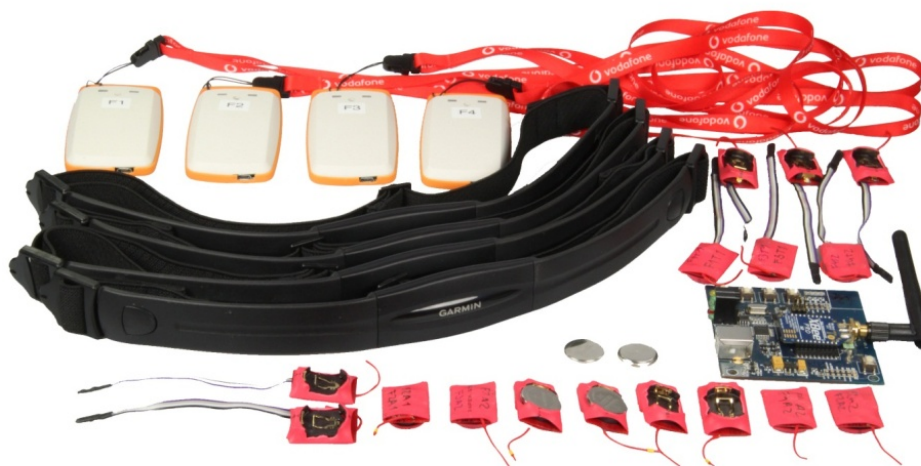
Obr. 4.5 Bezdrátová monitorovací jednotka postavená na platformě FlexiGuard Zdroj: (FBMI ČVUT a 1. LF UK CleverTech, s.r.o.)
