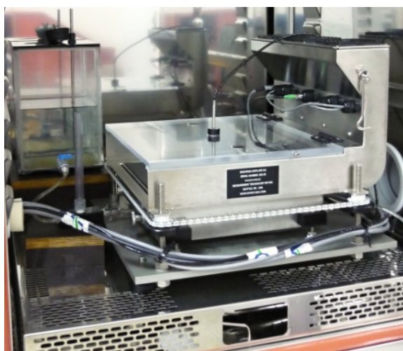
Obr. 2 SGHP – Model potící se teplé pokožky (SGHP) v klimatické komoře
