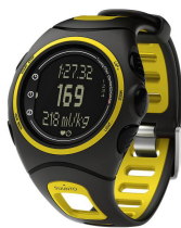
Obr. 4.3 Sport tester Suunto t6d, určený k snímání a monitorování tepové frekvence probandů. Zdroj: ( http://www.suunto.com )
