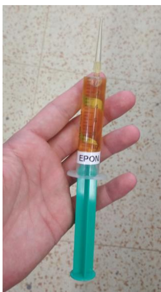
Obr. 25. EPON – epoxidová pryskyřice aceton
