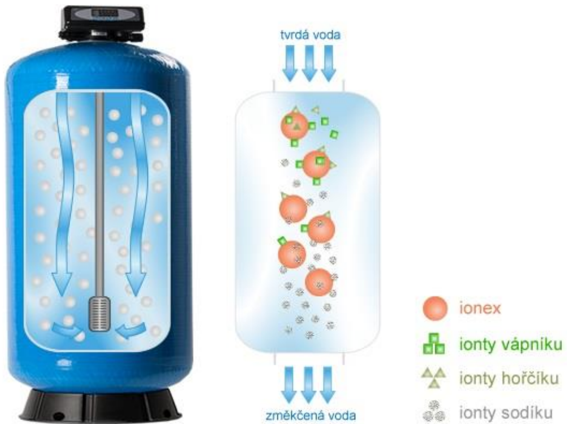
Obr. 10 Princip iontové výměny Zdroj: www.euroclean.cz
