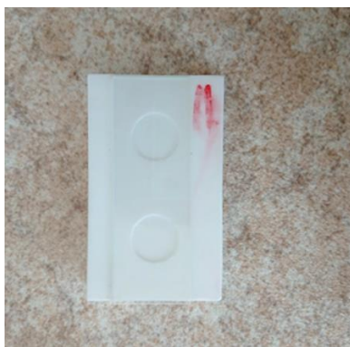
Obr. 80: Teflonová forma pro přípravu velmi tenkých gelových elektrolytů
