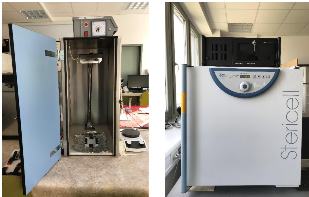
Obr. 13: UV komora s výbojkou CLEO HPA 400/300SD (vlevo) a sterilizátor Stericell (vpravo)
