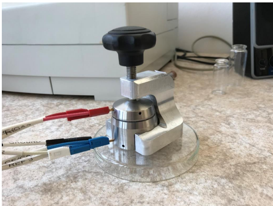
Obr. 15: Složená cela se vzorkem
