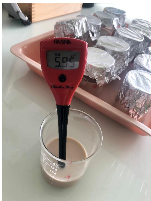
Obr. 21: Měření pH vzorku č.1 sladiny tmavé z pivovaru ČZU Suchdolský Jeník 2 týdny po přípravě.
