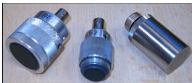
Obr. 4.1 Sondy použité při měření (1 MHz, 2,5 MHz, 5 MHz)
