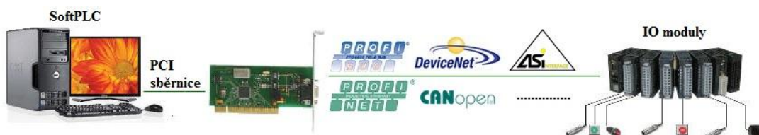
Obrázek 2.1 Uspořádání sítě se softwarovým PLC 1
