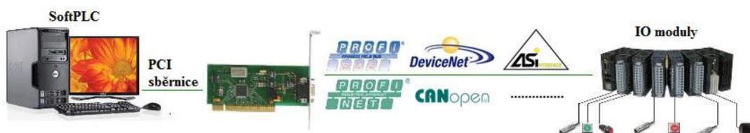
Obrázek 2.1 Uspořádání sítě se softwarovým PLC 1
