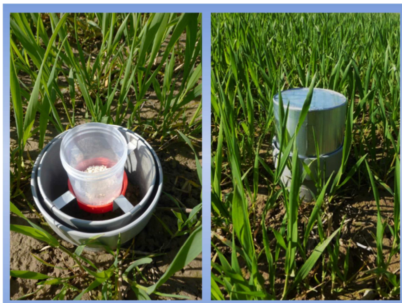
Obr. 12. Měření půdní respirace v terénu. Detail umístění PE nádoby s vysušeným natrokalcitem na nosnou konstrukci z nerezových pásků a dvojitý lem okraje prstence, do kterého se pro vzduchotěsné uzavření nalévá voda (systém vlastní konstrukce).
