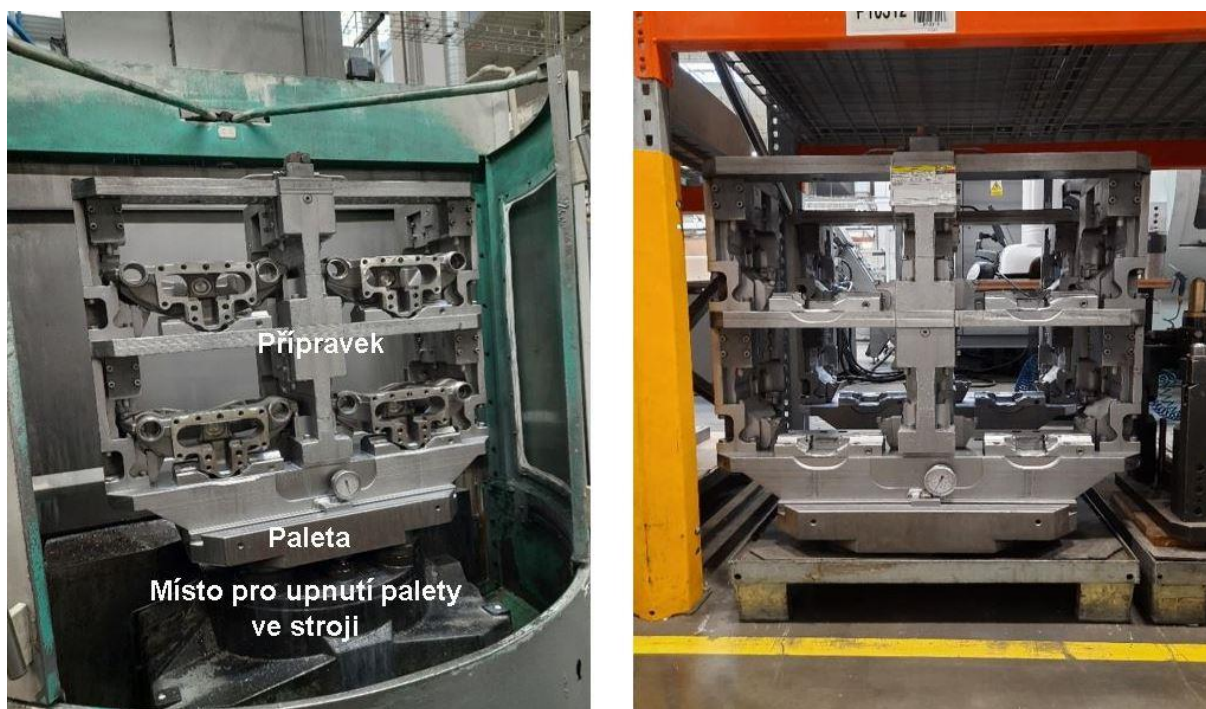
Obr. 10) Umístění přípravku na paletě ve stroji (vlevo) a mimo stroj (vpravo) ve firmě Knorr-Bremse
