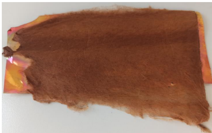
Obrázek 21- Tenčí připravená vrstva ligninových vláken
