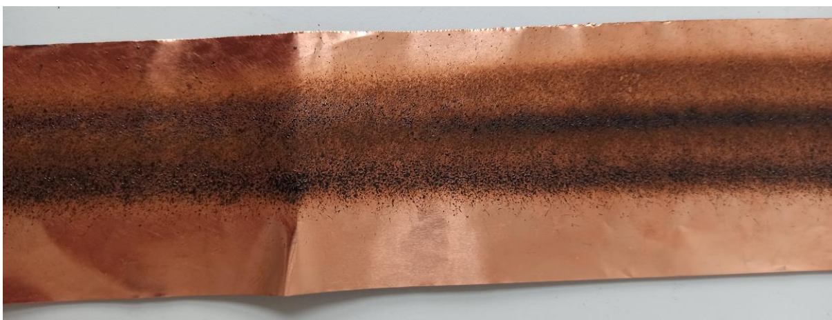
Obrázek 22- Pokus o přípravu vrstvy ligninu s nanočásticemi platiny ve zvláknovacím roztoku
