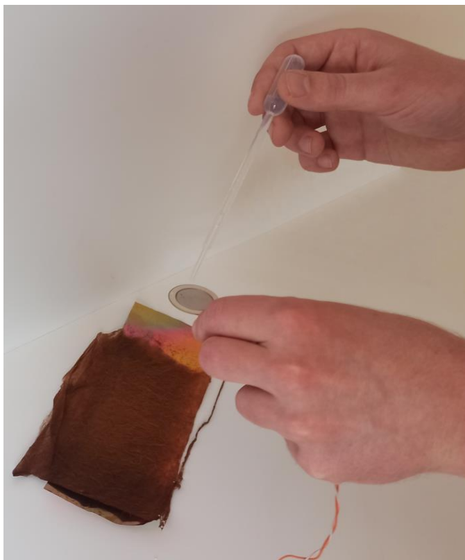
Obrázek 25- Nanášení platinových nanočástic pomocí piezoelektrického měniče
