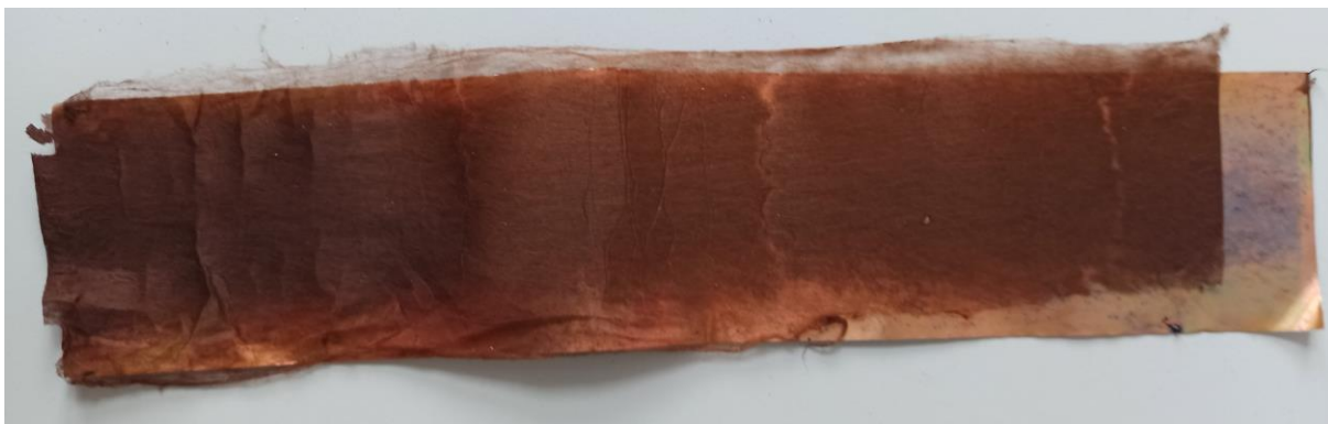
Obrázek 23- Připravená a stabilizovaná ligninová vrstva vláken
