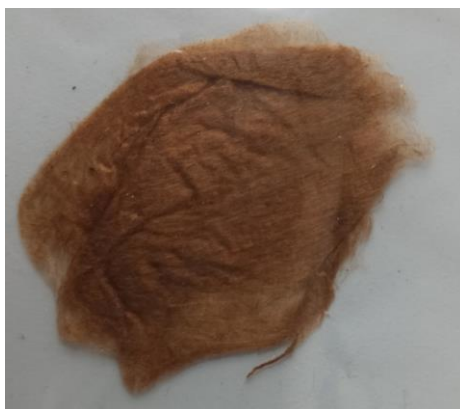
Obrázek 20- Nadýchanější připravená vrstva ligninových vláken
