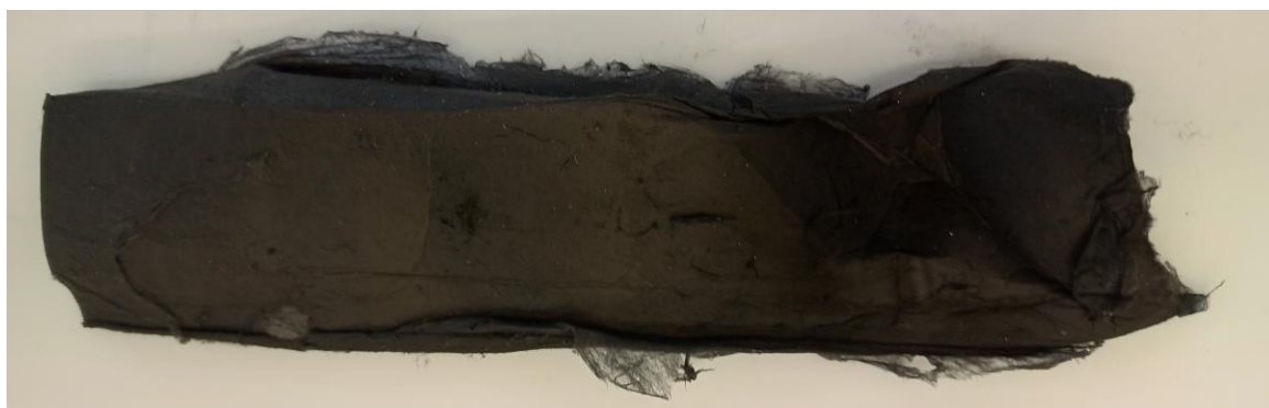
Obrázek 24- Karbonizovaná vrstva ligninových vláken
