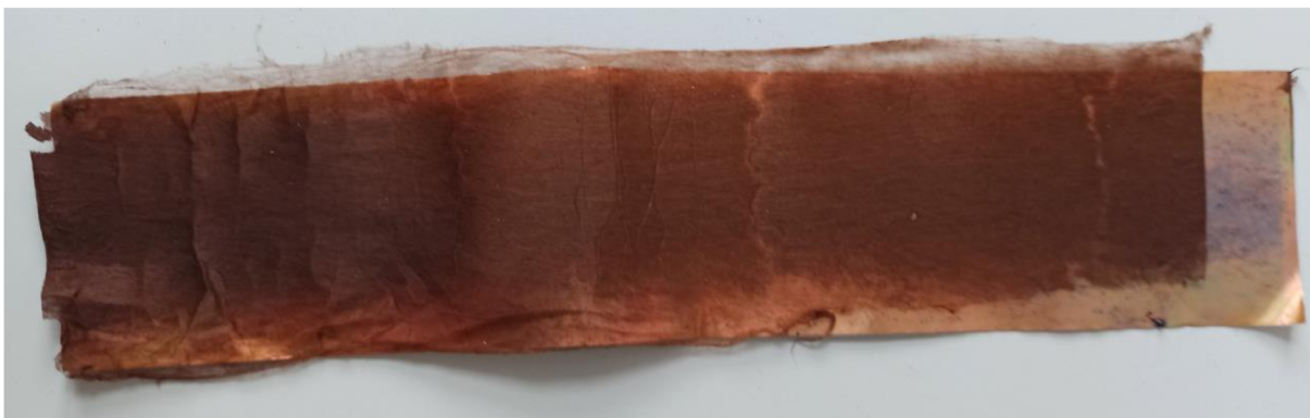
Obrázek 23- Připravená a stabilizovaná ligninová vrstva vláken
