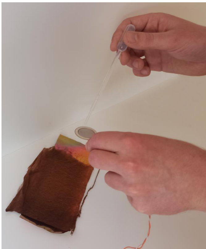
Obrázek 25- Nanášení platinových nanočástic pomocí piezoelektrického měniče
