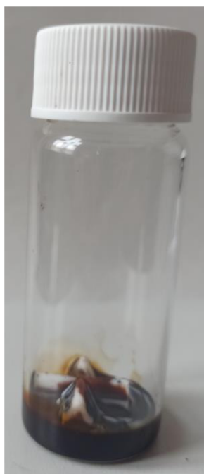
Obrázek 12- Připravený zvlákňovací roztok ligninu bez nanočástic míchaný křížovým magnetickým míchadlem
