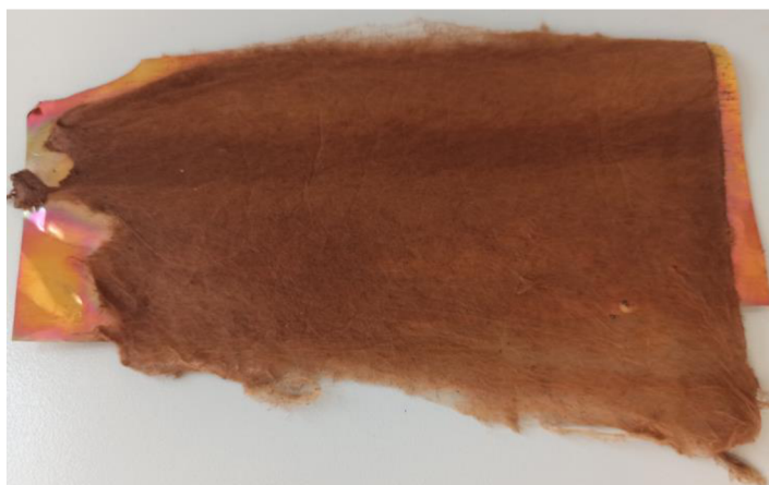
Obrázek 21- Tenčí připravená vrstva ligninových vláken
