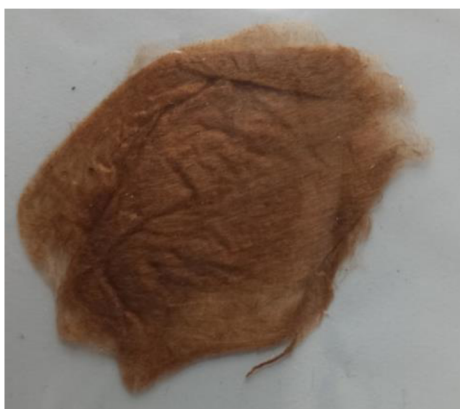
Obrázek 20- Nadýchanější připravená vrstva ligninových vláken
