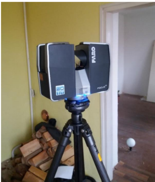
Obr. 6 FARO Focus 3D při měření [23]
