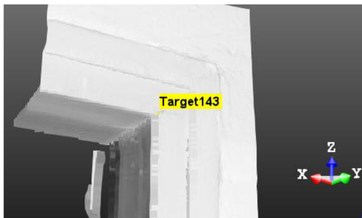
Obr. 13 Manuální označení kontrolního bodu na rámu dveří
