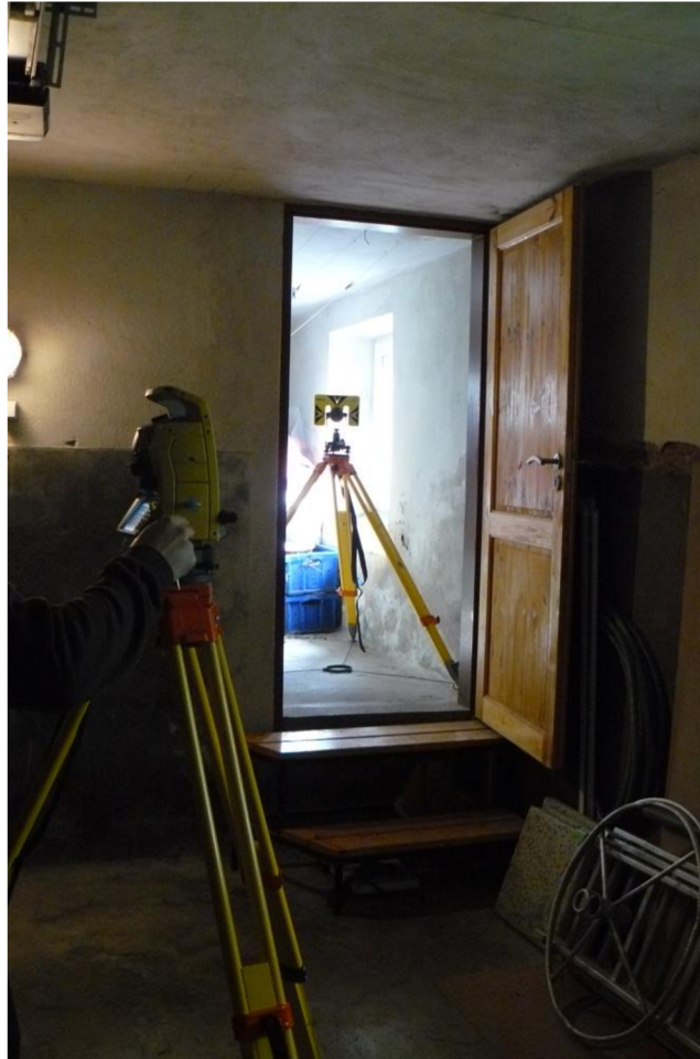
Obr. 8 Měření totální stanicí v suterénu
