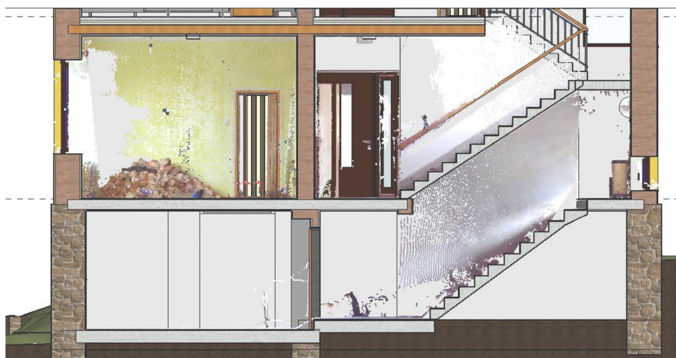
Obr. 25 Řez objektem s mračnem bodů
