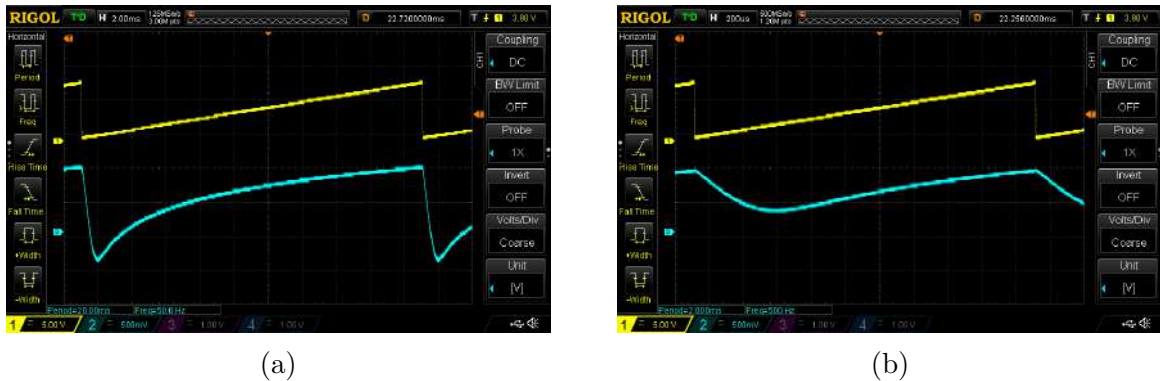
Obrázek 4.6: Snímek obrazovky osciloskopu. Zobrazení úbytku napětí na výstupním signálu (zploštění světle modré logaritmické křivky) v závislosti na frekvenci vstupního signálu pro a) 50 Hz, b) 500 Hz.
