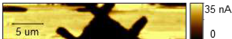
Obrázek 5.8: Lokální vodivost mřížky s nevodivou vrstvou měřená pomocí samosnímací sondy.
