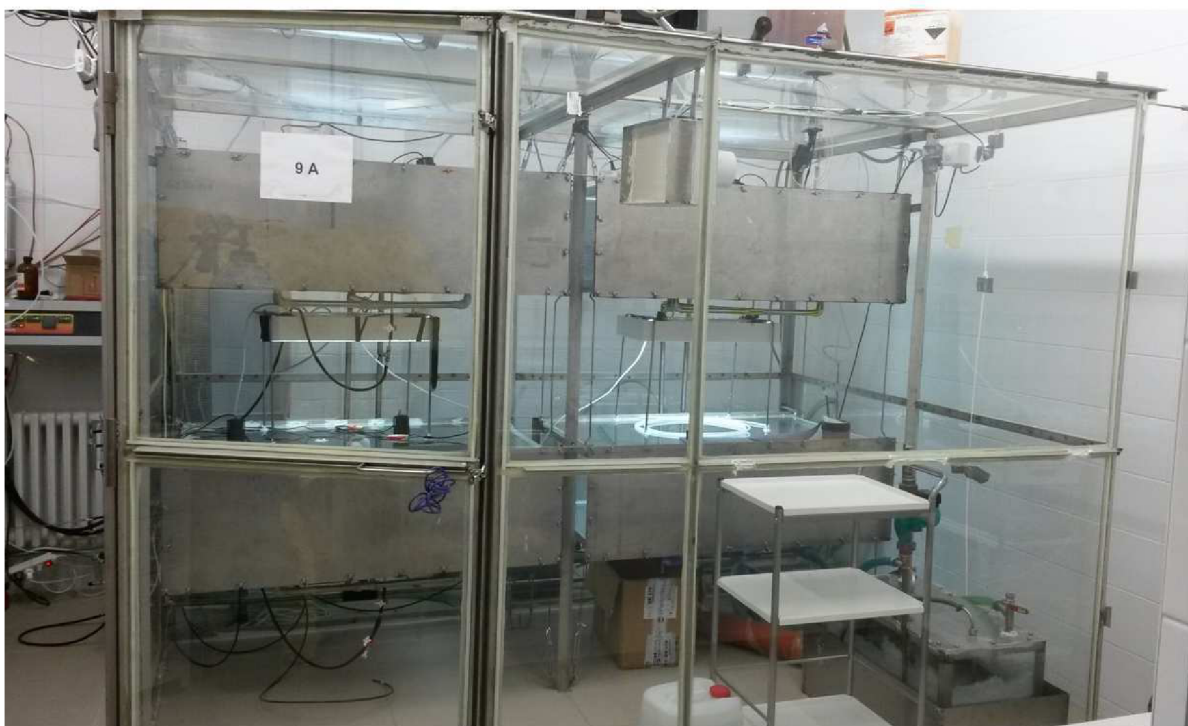
Obr. 4: Inhalační komora, která obsahuje čtyři nerezové inhalační klece.
