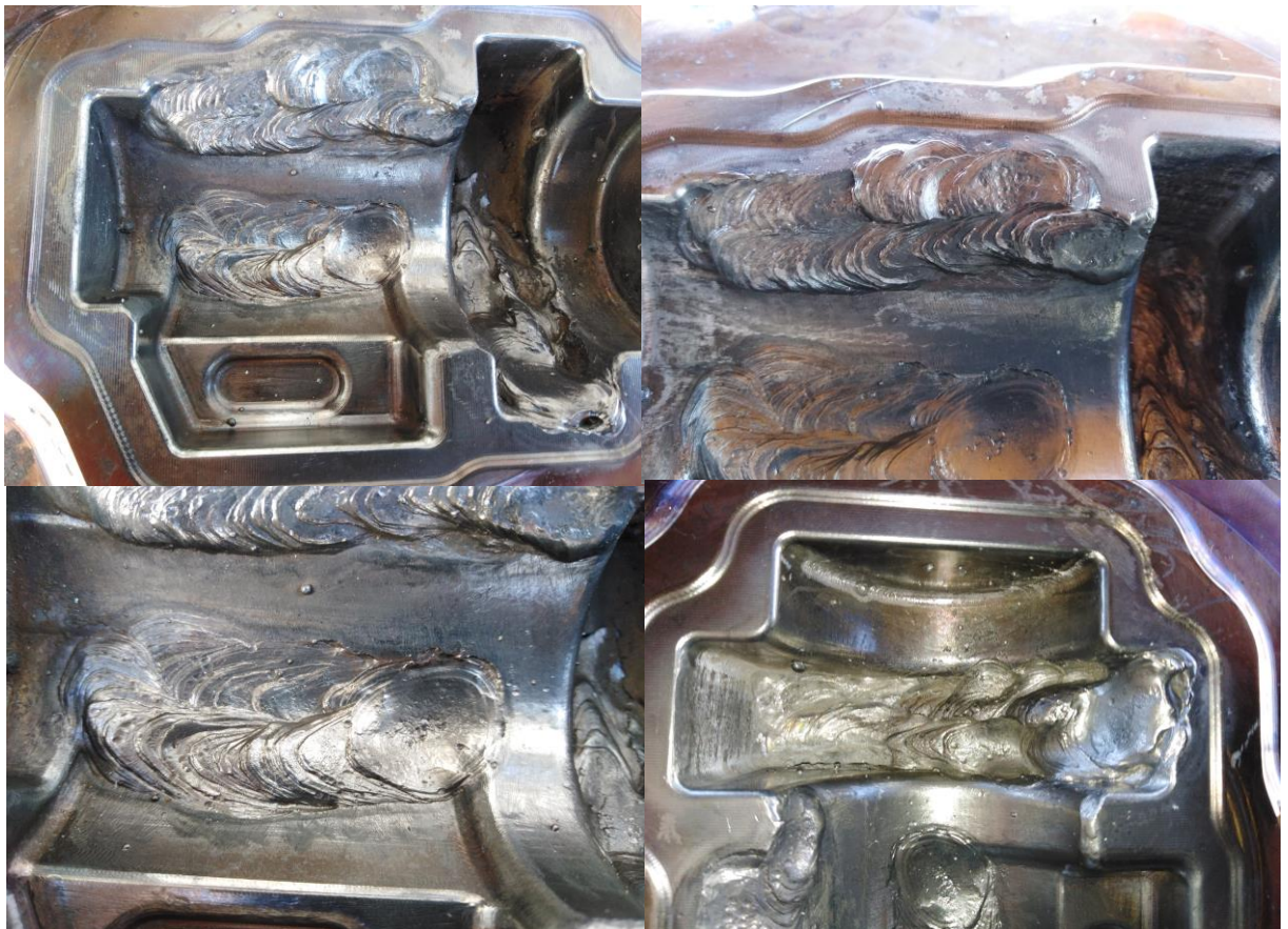
Obr. 54 Vyvaření dutiny vložky po očištění návarů
