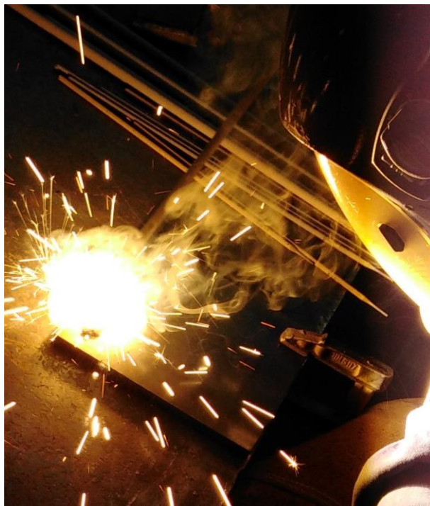
Obr. 16 Navařování obalenou elektrodou (drátu), obalu nebo kombinací obou možností.
