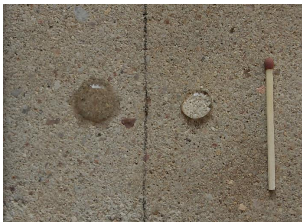
Obr. 2: Stav nasákavosti materiálu těsně po navlhčení (pravá strana ošetřena přípravkem)
