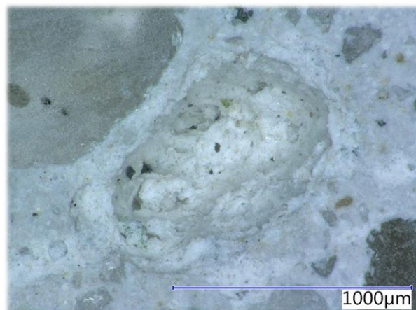
Obr. 68 Detail mikrostruktury vzorku dle receptury B_SA_2.5 při zvětšení 200x
