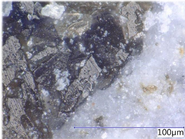
Obr. 52 Detail mikrostruktury vzorku dle receptur B_Glass_30 při zvětšení 2000x
