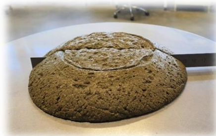
Obr. 13 Stanovení konzistence čerstvé malty metodou sednutí rozlitím
