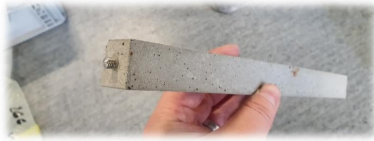
Obr. 19 Vzorek pro stanovení objemových změn trámečkovou metodou
