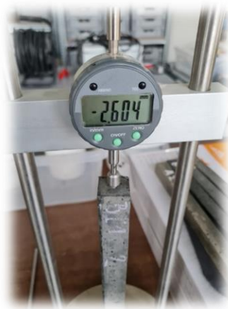
Obr. 18 Vzorek při stanovení objemových změn trámečkovou metodou
