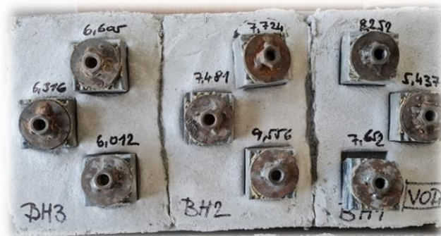
Obr. 16 Stanovení přídržnosti malty k hladkým nenasákavým obkladovým prvkům v etapě IV. této práce
