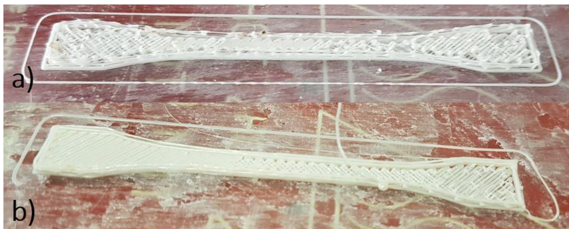
obr. 5-2 fotografie nepovedených výtisků a) ucpání trysky b) nedostatečný průtok materiálu
