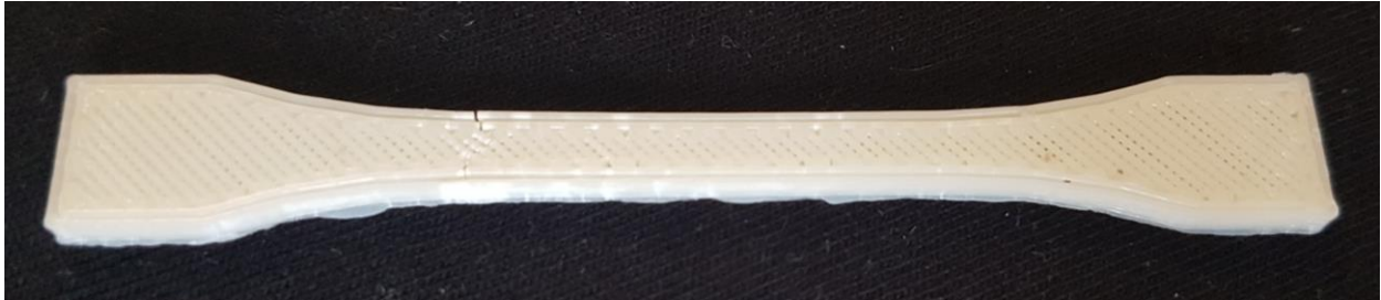
obr. 5-3 fotografie použitého tělesa na tahovou zkoušku
