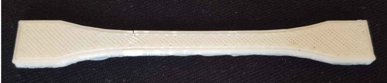
obr. 5-3 fotografie použitého tělesa na tahovou zkoušku
