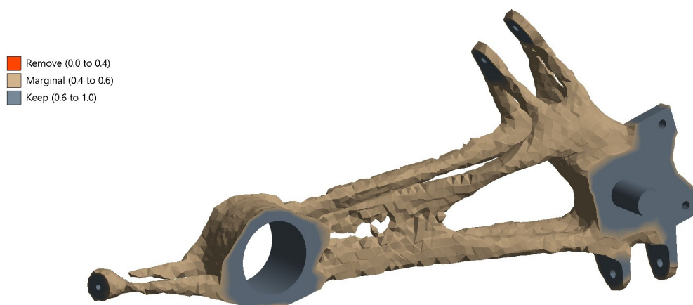
Obrázek 59: Výsledek topologické optimalizace podélného ramena
