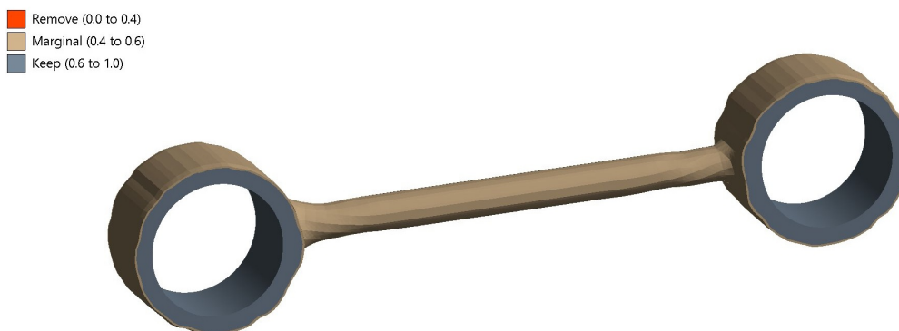
Obrázek 40: Výsledek topologické optimalizace sbíhavostního ramena
