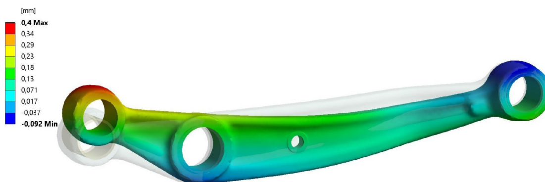
Obrázek 33: Deformace spodního ramena při zatáčení na vnějším kole
