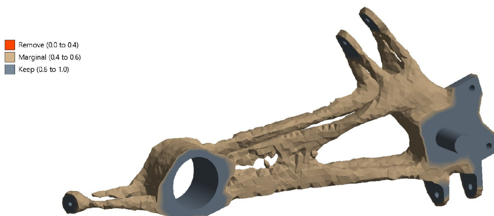
Obrázek 59: Výsledek topologické optimalizace podélného ramena
