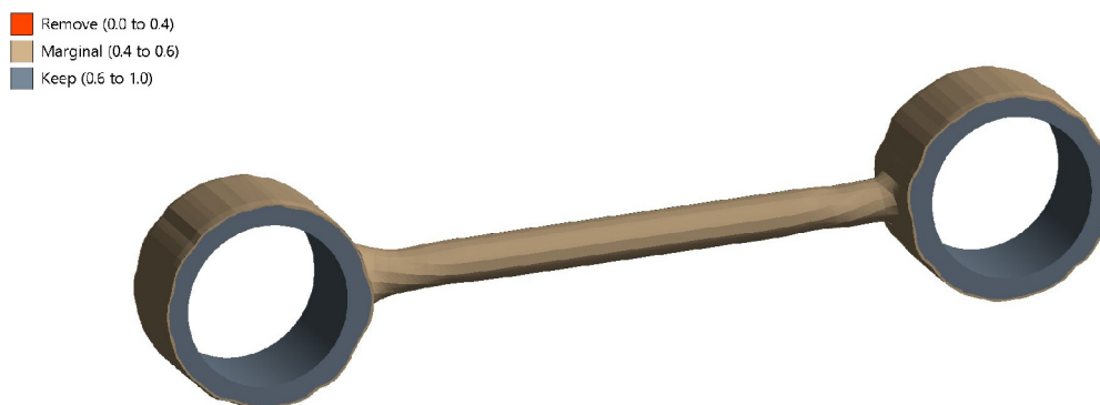
Obrázek 40: Výsledek topologické optimalizace sbíhavostního ramena
