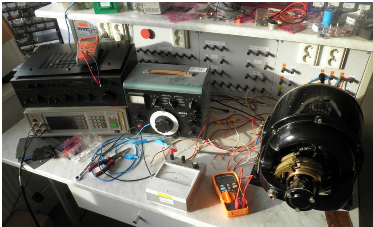
Obr. 3-6: Složený motor na pracovišti pro měření odporů a indukčnosti
