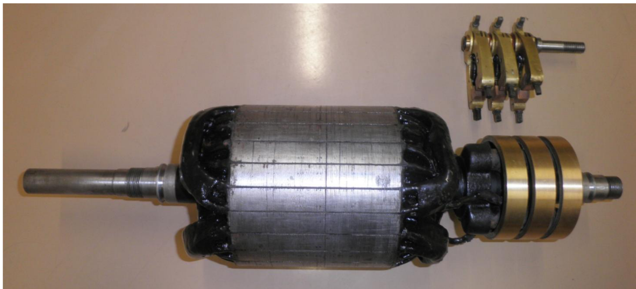
Obr. 3-1: Rotor se sběracími kroužky a mosazné držáky s uhlíky
