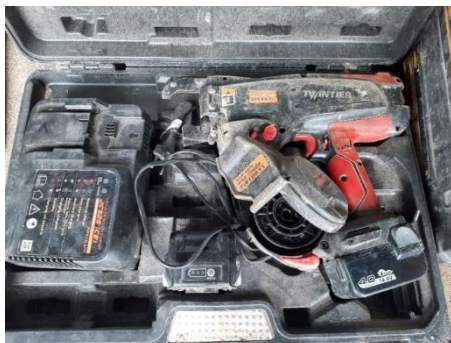
Obrázek 116- [foto autor] AKU vazač armatur MAX
