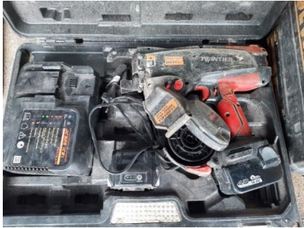
Obrázek 77- [foto autor] AKU vazač armatur MAX
