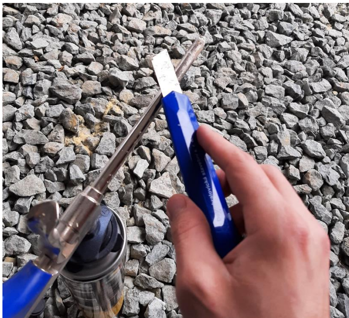
Obrázek 127 [foto autor] příprava PUR pěny před použitím
