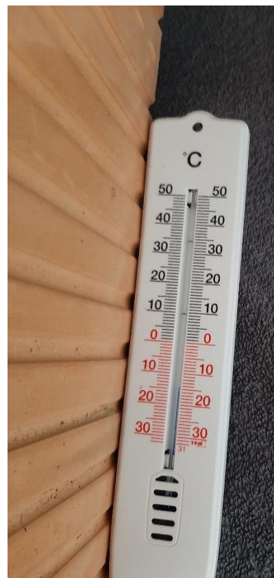
Obrázek 126 [foto autor] Uložení zdících prvků do mrazničky při teplotě - 16 °C
