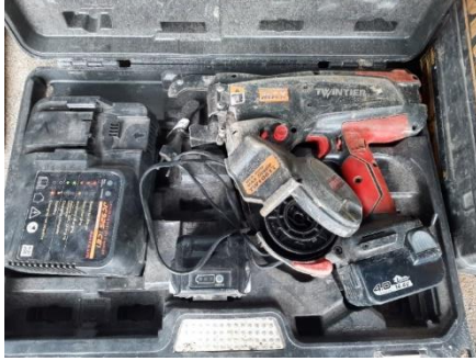
Obrázek 65- [foto autor] AKU vazač armatur MAX
