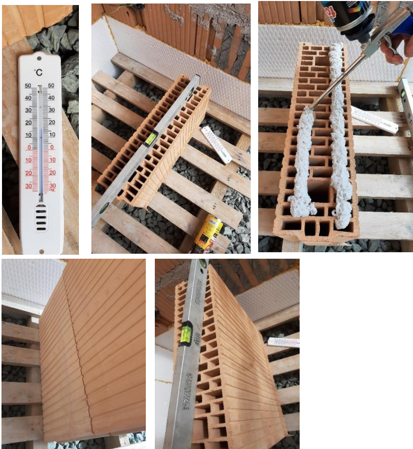
Obrázek 128 [foto autor] spojování zdících prvků VZOREK 1
