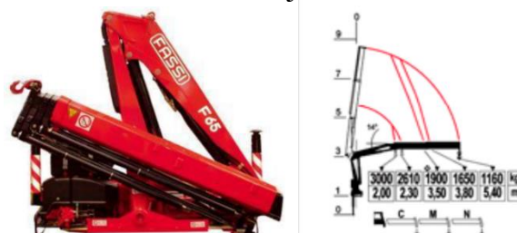
Obrázek 90 [28] Hydraulický nakládací jeřáb FASSI včetně křivky nosnosti
