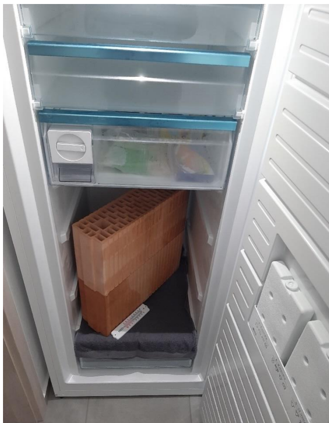
Obrázek 126 [foto autor] Uložení zdících prvků do mrazničky při teplotě - 16 °C
