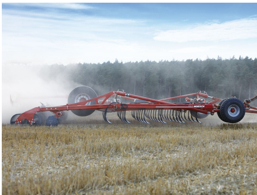
Obr. 7 – Stroj pro mělké zpracování půdy od firmy Horsch, Cruiser 7 XL (zdroj: Horsch)
