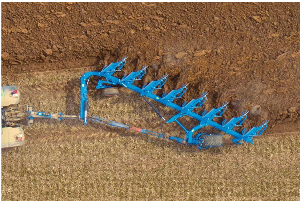
Obr. 5 – Osmiradličný pluh Lemken vari-diamnt (zdroj: Lemken)
