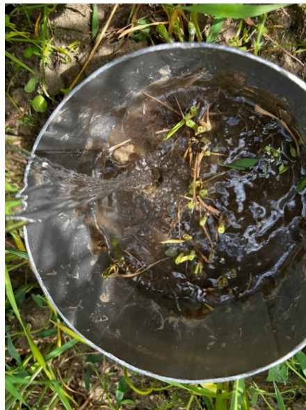
Obr. 10 – Vlévání vody do válce (foto Fáber)
