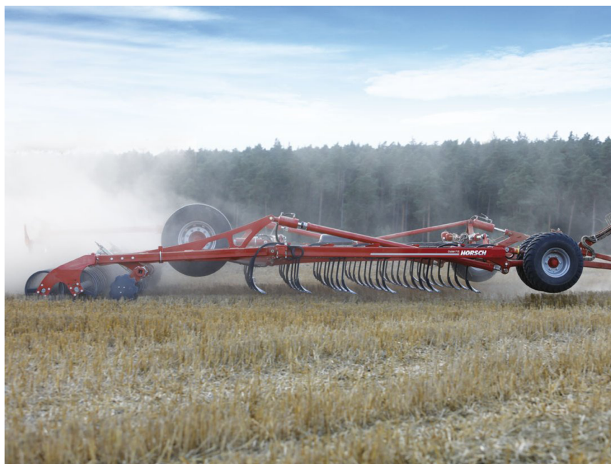
Obr. 7 – Stroj pro mělké zpracování půdy od firmy Horsch, Cruiser 7 XL (zdroj: Horsch)
