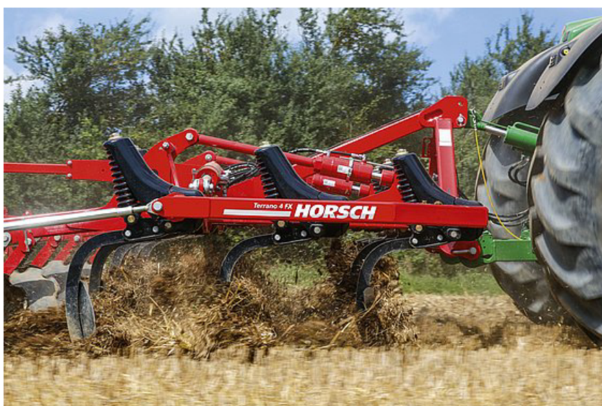
Obr. 6 – Stroj pro hluboké kypření Horsch Terrano fx s radličkami MulchMix (zdroj: Horsch)
