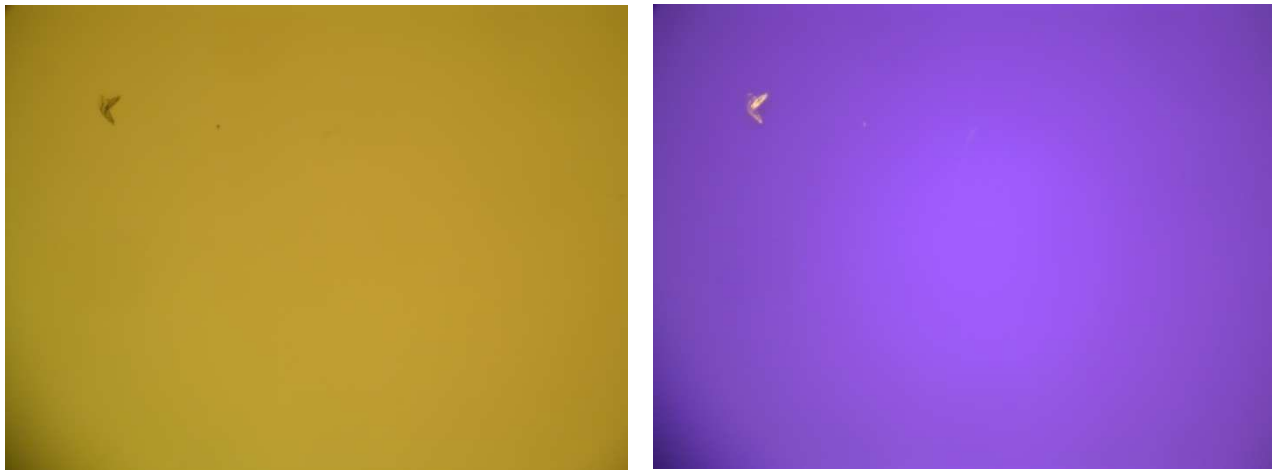
Obrázek 13: Mikrofotografie tenké vrstvy Tg-PPV + PCBM; vpravo při použití polarizačního filtru
