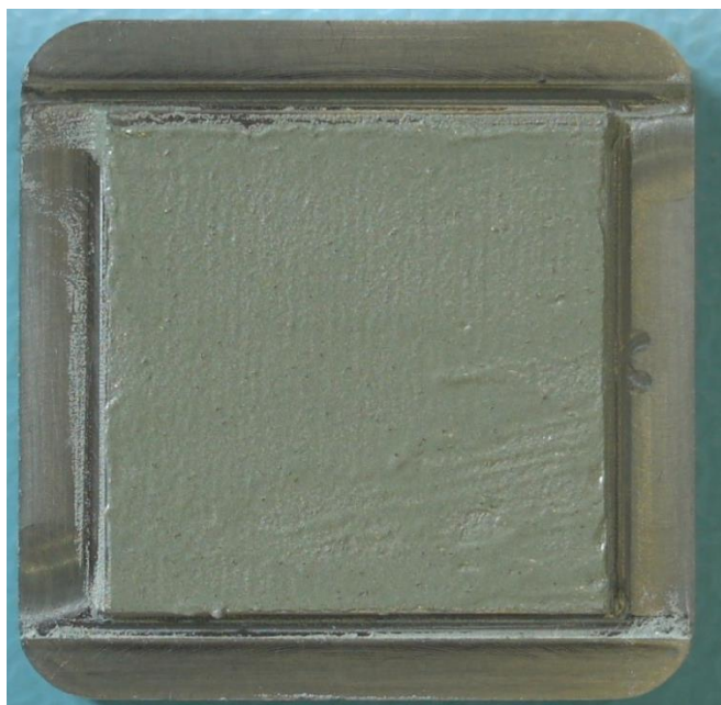
Obr. 55: Vytvořená rovinná vrstva pájecí pasty pro dipping
