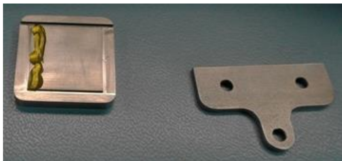
Obr. 38: Přípravek pro dipping s naneseným tavidlem a stěrka pro vytvoření filmu
