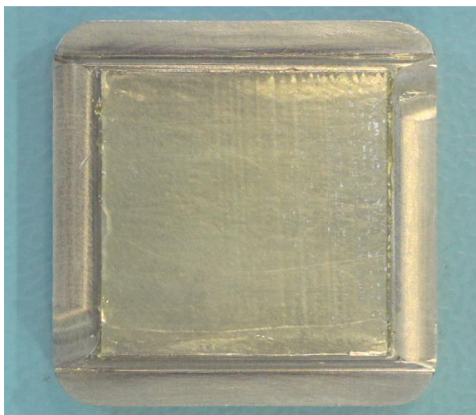
Obr. 42: Vytvořený film z tavidla \alpha v aplikačním přípravku
