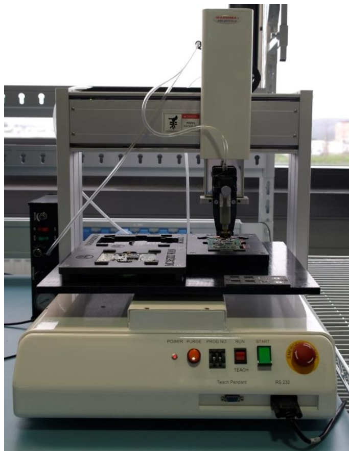
Obr. 20: Testovací pracoviště s dispenzerem
