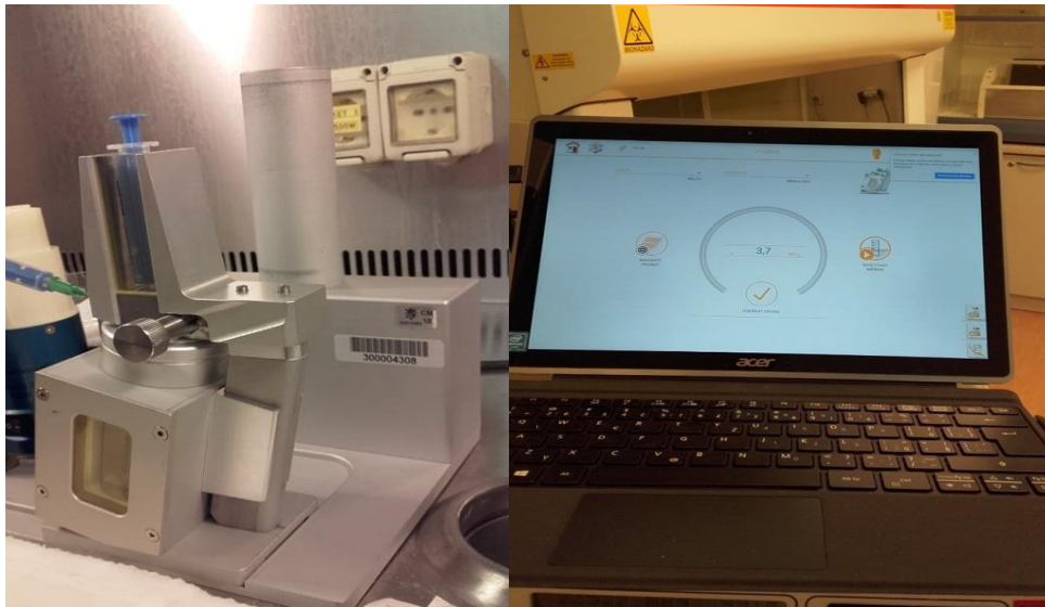
Obrázek 10 Přístroj PT 342R4 od firmy LYNAX, pro měření dávky (vlastní zdroj).
