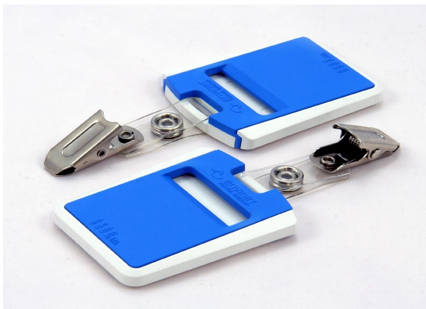
Obrázek 7 Osobní filmový dozimetr (Faktum design, 2004)
