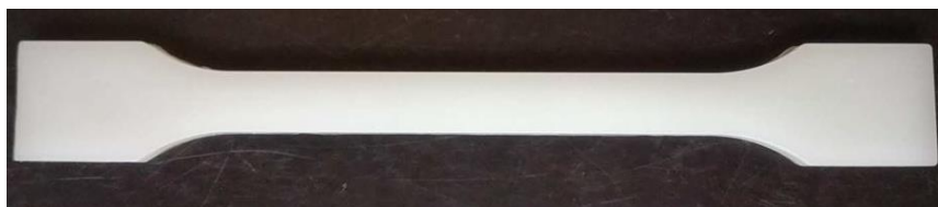
Obrázek 25 – Fotografie vzorku kompozitu pro tahovou zkoušku dle ČSN ISO 527-1 a ČSN
