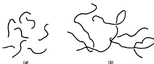
Obrázek 5 – Struktura zapletených a nezapletených polymerů. A) nezapletený řetězec, nízká molekulová hmotnost; B) zapletený řetězec s vysokou molekulovou hmotností 6
