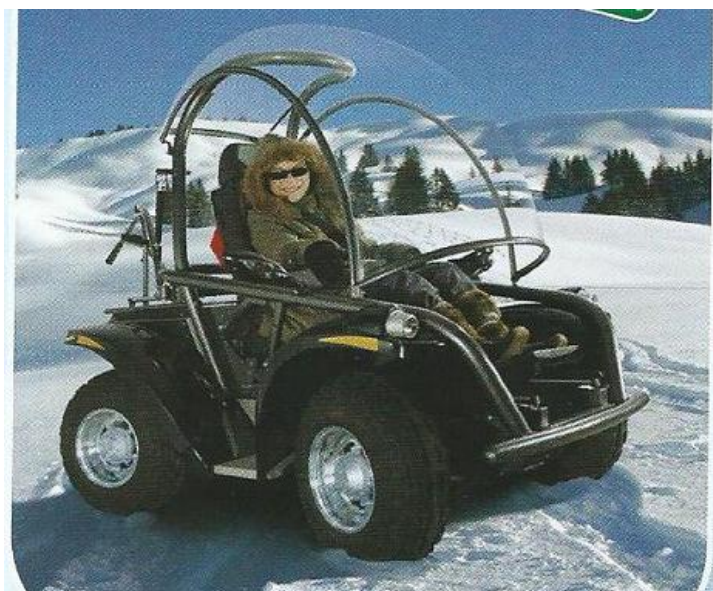
Obrázek č. 3: SuperFour-vozík do terénu s hybridním pohonem
