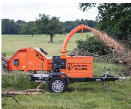
Obr. 32 Drtič s výfukovým komínem [49]
