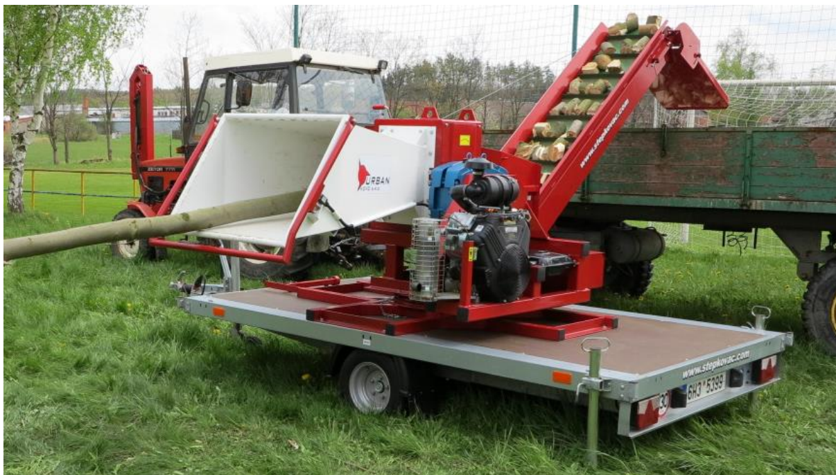
Obr. 34 Odvod materiálu za pomoci dopravníku [51]
