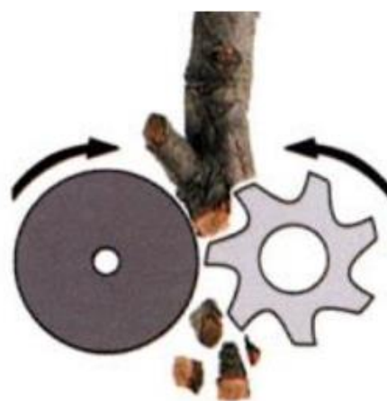
Obr. 10 Obr. 9 Princip funkce frézovacího mechanismu s opěrným válcem [12]
